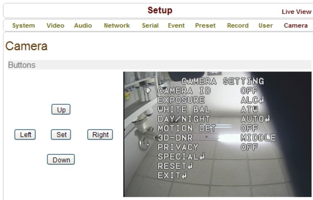
Здесь производится настройка параметров аналоговой части камеры. Экранное меню камеры отображается на дисплее после нажатия на кнопку «Установить» («Set») и навигация по нему осуществляется с помощью кнопок вверх-вниз и влево-вправо.
