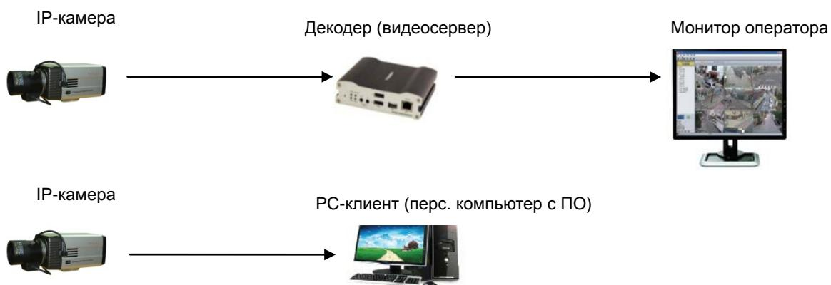
IP-камера установлена на объекте видеонаблюдения и передаёт видеоданные. Персональный компьютер с установленным ПО или декодер установлены в центре видеонаблюдения и принимают и отображают видеоданные на аналоговом мониторе оператора. Аудиоданные и данные телеметрии передаются в обоих направлениях.
