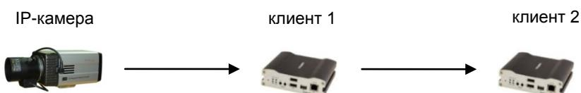
Видео и аудио данные могут быть ретранслированы от одного клиента другому. Такой режим используется в случае ограниченной ширины канала, связывающего IP-камеру с центром видеонаблюдения (клиент1) – он позволяет ретранслировать данные от этой камеры множеству другим клиентам, не используя ограниченный канал связи.
